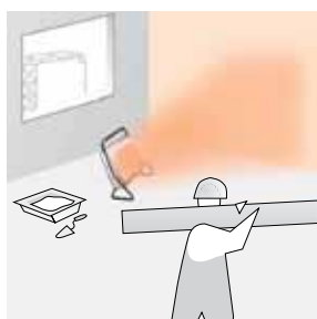
Asciugatura di parete in costruzione.
