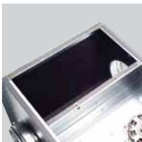
Isolamento acustico Versioni isolate (modello ISO): dotati di isolamento acustico in lana di vetro dello spessore di 25 mm (certificate M0).
