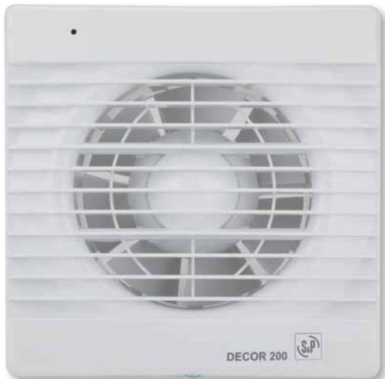
Ventilatori elicoidali extrapiatti, con serranda anti-ritorno incorporata; portata di circa 200 m<sup>3</sup>/h, spia luminosa di funzionamento e motore 230V 50Hz, Classe II, IPX4, con protezione termica per temperatura di esercizio fino a 40°C.
