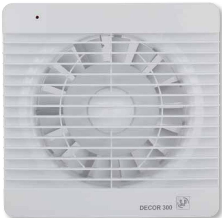
Ventilatori elicoidali extrapiatti, con serranda anti-ritorno incorporata; portata di circa 300 m<sup>3</sup>/h, spia luminosa di funzionamento e motore 230V 50Hz, Classe II, IPX4, con protezione termica per temperatura di esercizio fino a 40°C.
