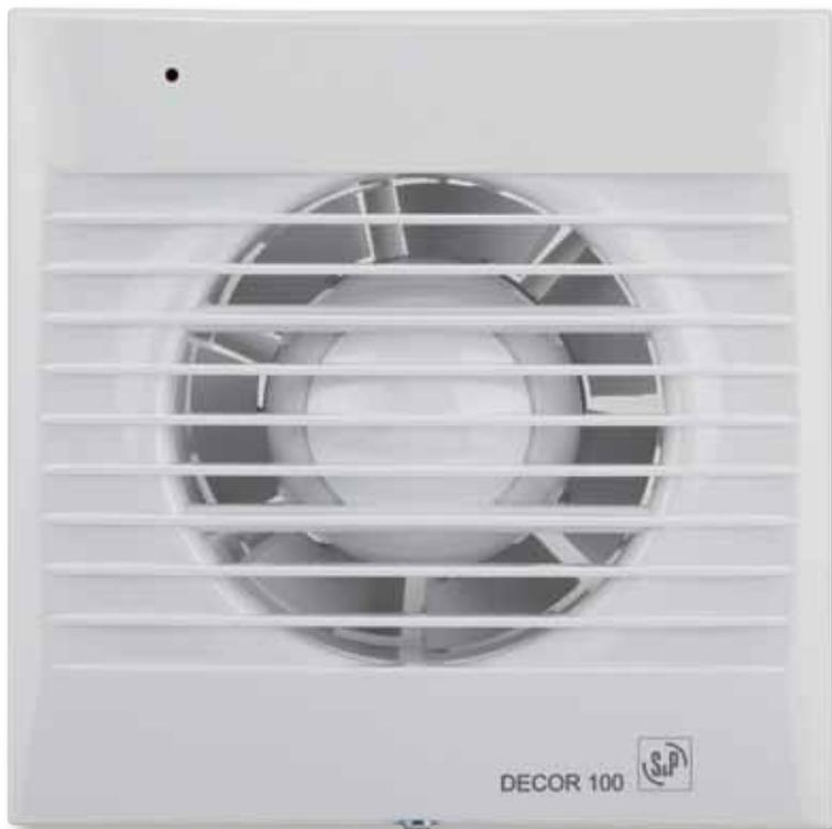
Ventilatori elicoidali extrapiatti, con serranda anti-ritorno incorporata; portata di circa 100 m<sup>3</sup>/h, spia luminosa di funzionamento e motore 230V 50Hz, Classe II, IPX4, con protezione termica per temperatura di esercizio fino a 40°C.
