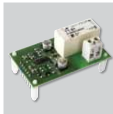
TTS-1 Il modulo aggiuntivo TTS-1 permette di incrementare la potenza massima collegabile al TTC-2000 fino a 30 kW.
