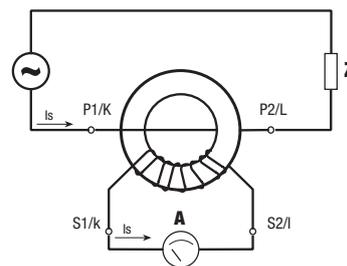
Nel collegamento di tutti i trasformatori amperometrici è importante rispettare i sensi di percorrenza della corrente.
