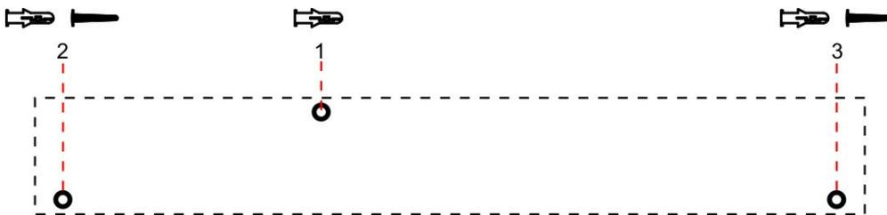
2.1.2.3 Agganciare la fessura della staffa sul retro del riscaldatore come mostrato sotto sulla testa di due viti avvitate (posizione 2 e 3)
