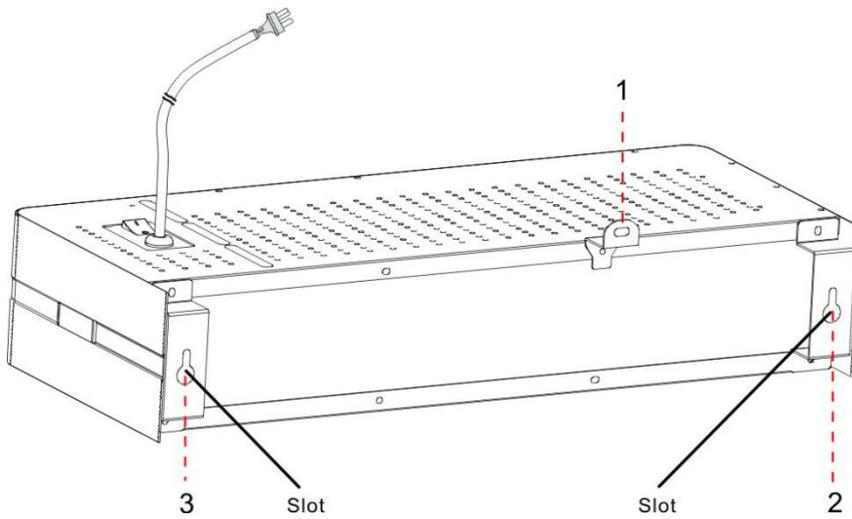
2.1.2.4 Avvitare saldamente la vite M5 x 30mm nel tassello (posizione 1).
