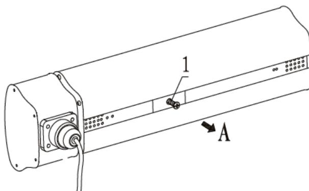
2.3.3: Fissare il set di staffe (n.2 dell'elenco degli accessori) sul riscaldatore con la vite M6x16, che è stata svitata al passaggio 1
