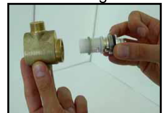
6 - Entfernen und Ersetzen der Patrone
