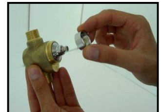
4 - Entfernen der inneren Ringmutter
