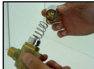
3 - Entfernen Sie die Taste und die Feder
