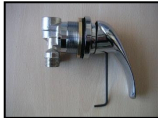
12 - Lösen der Schraube des Griffs
