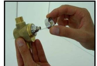
4 - Entfernen der inneren Ringmutter
