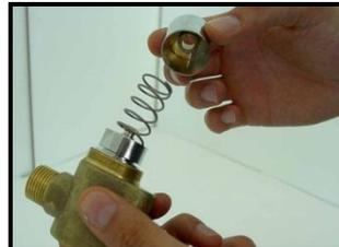
3 - Entfernen Sie die Taste und die Feder
