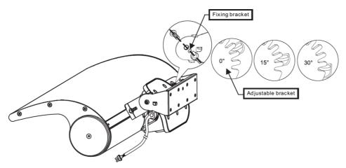
3. Fissare il riscaldatore e la staffa di fissaggio alla staffa di montaggio a soffitto utilizzando i bulloni preinstallati sulla staffa di montaggio a soffitto. I bulloni devono essere avvitati attraverso i fori contrassegnati con **D**
