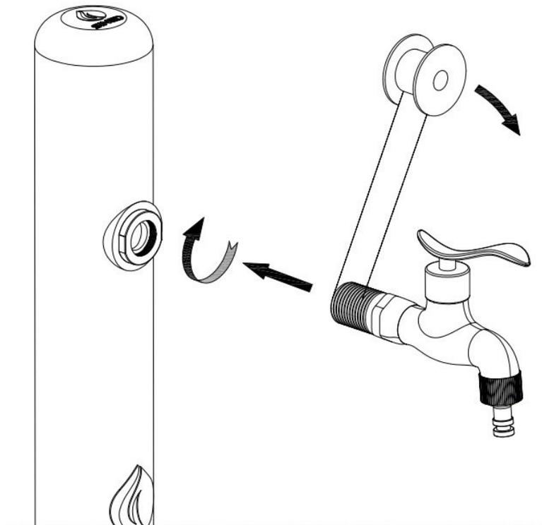
Avant d'installer le robinet, assurez-vous que la rondelle en caoutchouc est correctement positionnée.
