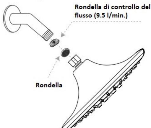
Si une pression plus élevée est souhaitée, la rondelle de contrôle de débit peut être retirée.
