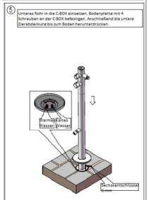
Edelstahl-Duschen Anleitungen zum Anschluss von Warm- und Kaltwasserleitungen mit integrierter C-BOX Vorrichtung
