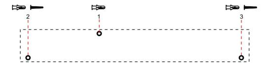
2.1.2.3 Enganche la ranura del sºpºrte en la parte pºsteriºr del calentadºr cºmº se muestra a cºntinuación en la cabeza de dºs tºrnillos at@rnilladºs (pºsición 2 y 3)
