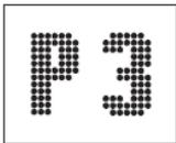
Pulse los botones "LOW", "MED" y "HIGH" del mando a distancia, la estufa funcionará con los ajustes de potencia LOW y MED, HIGH, y el símbolo "P1" "P2" "P3" se mostrará en la zona de la pantalla.
