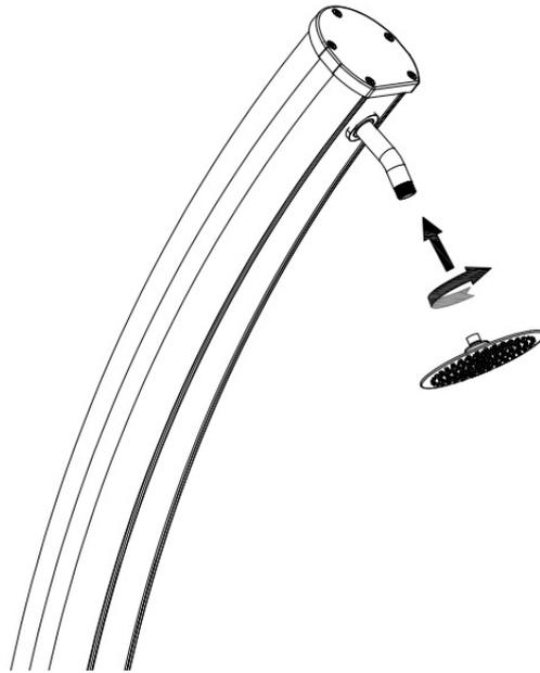
Antes de instalar el cabezal de la ducha, asegúrese de que las arandelas de goma están correctamente colocadas.
