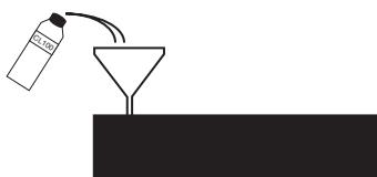
Au premier remplissage la pierre céramique doit être saturée avec le carburant Ruby Fires bio éthanol. Une partie du liquide restera toujours dans la pierre céramique. Pour cette raison il faut mettre plus de liquide au premier remplissage qu'aux remplissages suivants.
