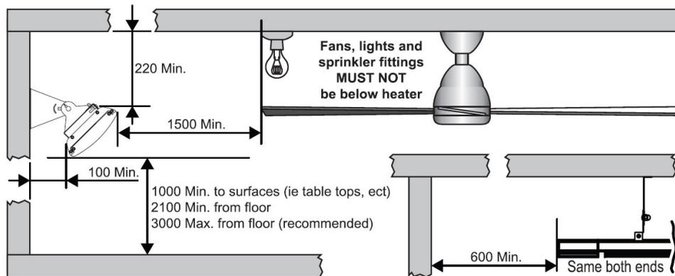
Mindestabstände für die Montage des Heizgeräts parallel zur Decke.
