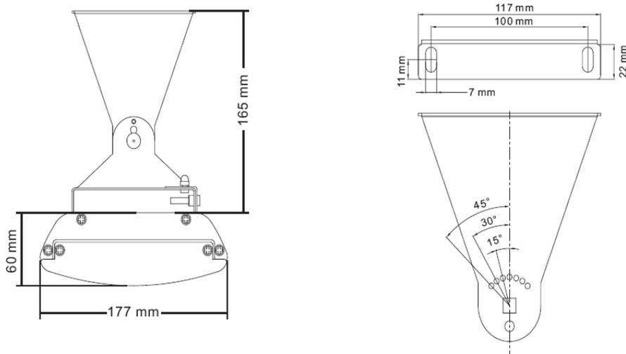
4. Der korrekte Installationsvorgang, wie in der obigen Abbildung dargestellt, wählt die Position des Heizgeräts an der Decke, indem der oder die Strukturstift(e) so positioniert werden, dass eine sichere Befestigung des Heizgeräts gewährleistet ist, wobei Mindestabstände zum Boden und andere Vorschriften beachtet werden.
