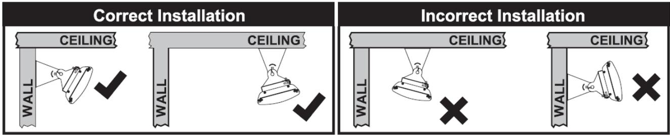
Warnung: Das Heizgerät darf niemals in einer nach oben oder innen gerichteten Position installiert werden, die Heizfläche muss immer so positioniert werden, dass die Wärme nach unten oder nach außen gerichtet ist.
