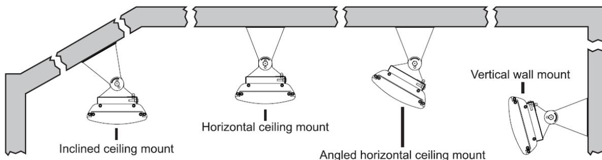
Die ideale Einbauposition ist direkt über dem zu beheizenden Bereich mit Längsausrichtung und vertikal nach unten gerichtet. Wenn dies nicht möglich ist, können die Heizung(en) an einer Wand montiert und nach unten geneigt werden.
