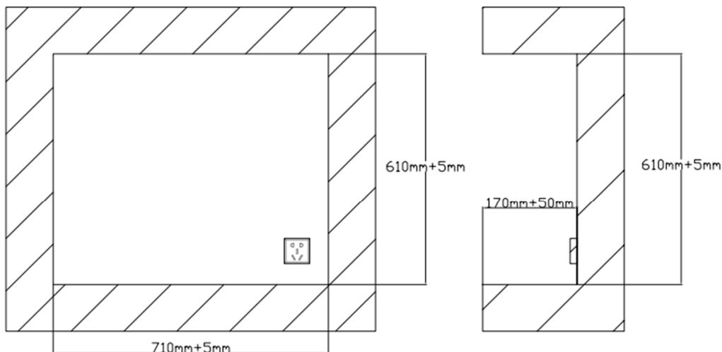
**HINWEIS:** Die genauen Abmessungen des Schrankes oder der Wandöffnung, in die der Kamin eingebaut werden soll, sind: Breite 715 x Höhe 615 (mm). Es wird empfohlen, bei der Planung der Öffnung eine Toleranz von +3 mm für die Breite und die Höhe zu berücksichtigen.
