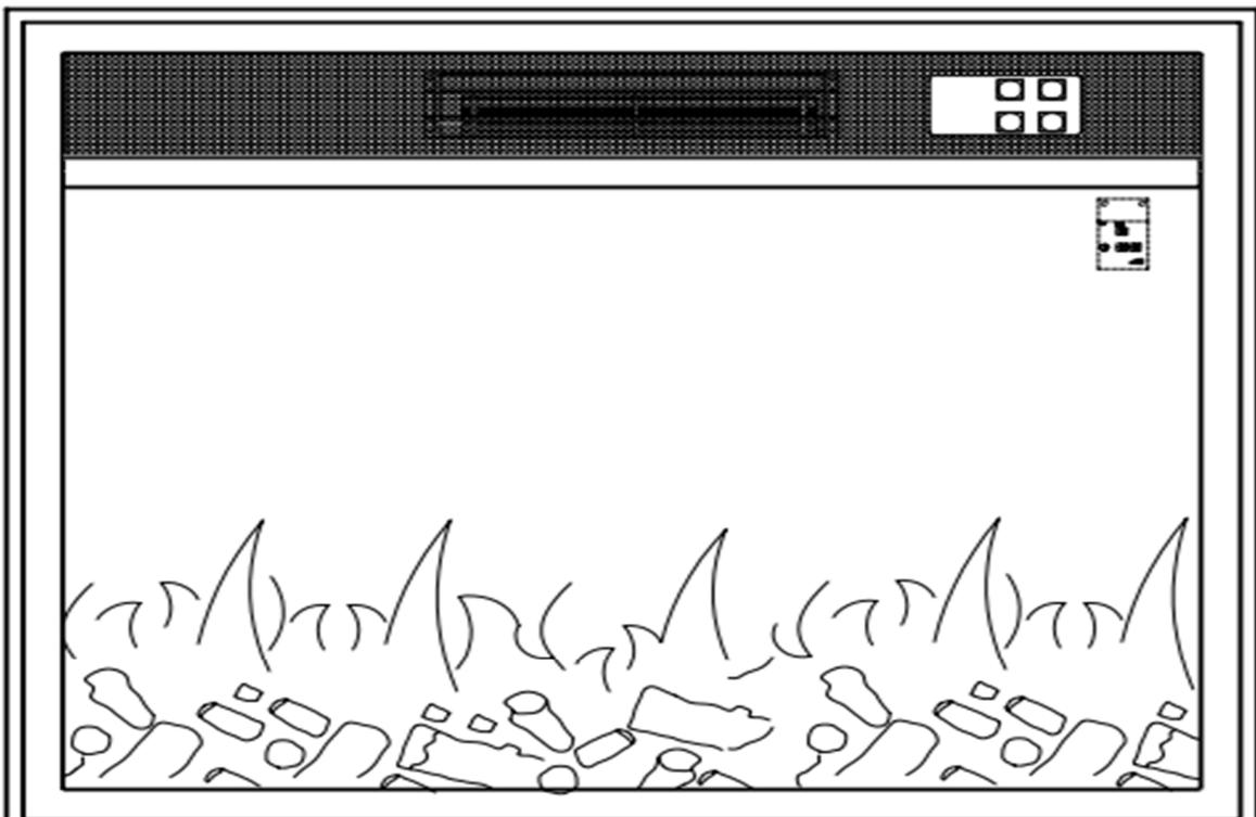
**Sicherheitstipp:** Um Brände zu vermeiden, dürfen sich keine Gegenstände innerhalb von 100 mm vor dem Heißluftauslassgitter befinden.
