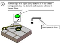
Inserte el tubo inferior en la C-Box, conecte la placa inferior a la C-BOX con 4 tornillos, empuje la capa inferior decorada hasta el suelo.
