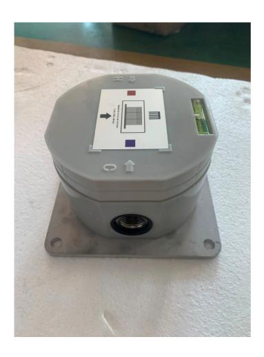
Die C-Box ermöglicht eine perfekte Installation und ist durch einen abschließbaren Deckel geschützt, der bei der Demontage der Dusche verwendet werden kann. Die C-Box muss vollkommen eben aufgestellt und mit 4 mitgelieferten Metalldübeln am Boden (auf Beton) befestigt werden.
