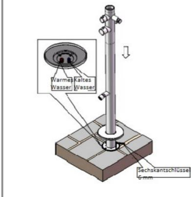
6 Das obere Rohr in das untere Rohr einsetzen, so dass die hinteren Linien der beiden Rohre ein Rechteck bilden. Die Schraube auf der Rückseite der Rohre festziehen, um die Montage abzuschließen. Die Handbrause mit dem flexiblen Schlauch verbinden, wenn die Dusche mit einem solchen ausgestattet ist (Hinweis: einige Bauteile können un installiert sein).
