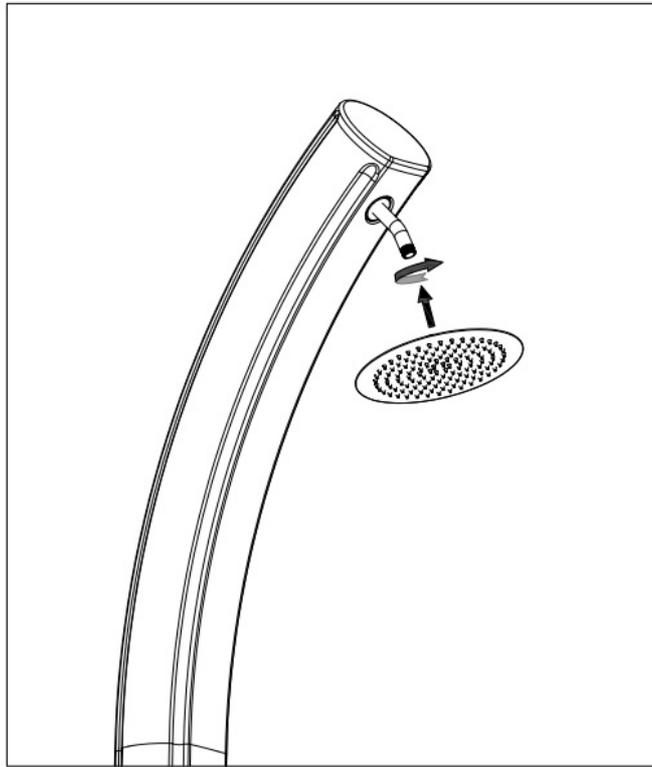
Vergewissern Sie sich vor der Montage des Duschkopfs, dass die Gummidichtungen richtig positioniert sind.
