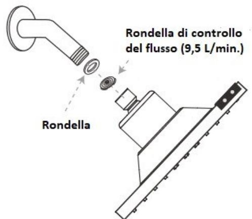
Wenn mehr Druck gewünscht wird, kann der Durchflussregler entfernt werden.
